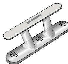
PREMIER -POLLARI 62003300 Alumiini Pohja: 88 x 444 mm Korkeus: 135 mm Kiinnitys: 3 x M16 Vetolujuus: 50 kN 92,50 €
